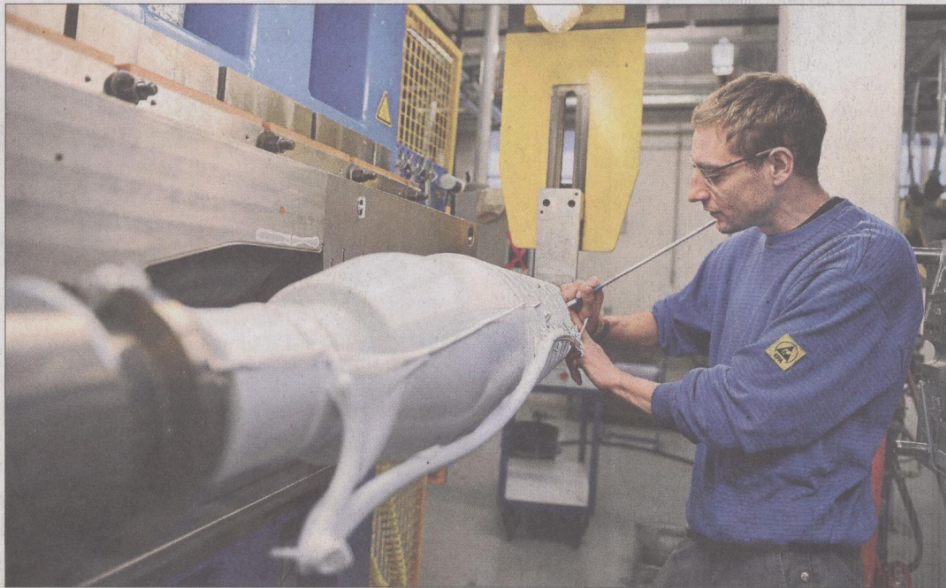
Die Firma Pfisterer Ixosil hat eine neuartige Technologie für die Endverschlüsse von Hochstromkabeln entwickelt. Das Bild zeigt Mitarbeiter Pascal Walker bei der Fertigung eines solchen Endverschlusses.
